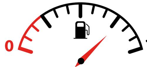
O 0 (zero) indica que o tanque está totalmente vazio, enquanto o 1 (um) indica que o tanque está totalmente cheio. Entre o 0 (zero) e o 1 (um), o ponteiro mostra a fração do tanque que está cheia de combustível.
